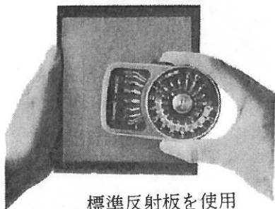
標準反射板を使用した代用測定 写真⑭
