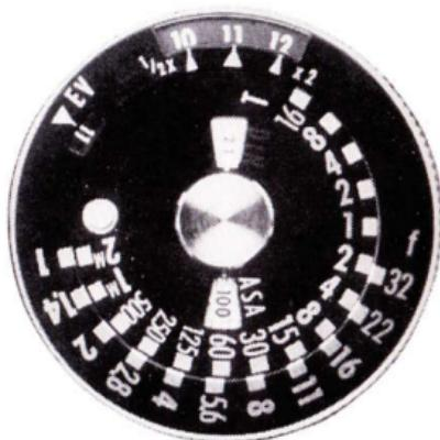
用測定する場合には被写体と同一光線の下で測定して下さい。トップライト、側面光等の場合は、カメラの方へ向けた値と主光源へ向けた値の中間をとります。
