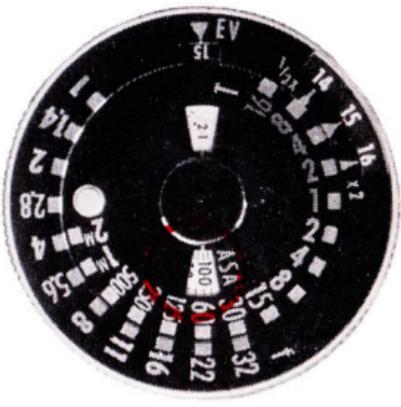
次に外側のダイヤルを廻して読み取った数値13に、ダイヤル上有る3つの三角印のうち中央の印を合せて下さい。(右上写真参照)
