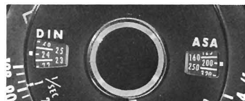
反射光のときはフィルム感度を2倍に
