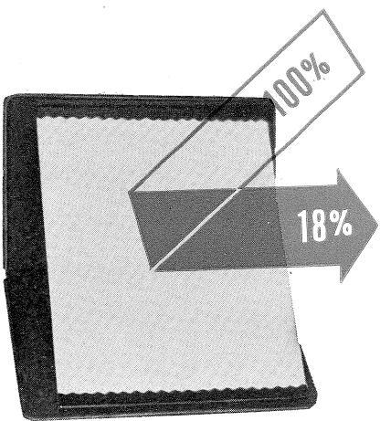
被写体の反射光線の明暗の平均を簡単に得るために標準反射板を利用すれば便利です。標準反射板は標準反射率18%の無彩色に塗られているものですからどんな状態の光線の場合でもその時の光線の18%より反射して来ませんから、いつも標準の値、つまり平均した値が得られるわけです。明暗各種のコントラストがある場合には簡単に中間の値が得られるわけです。この場合には標準反射板を被写体の面に正しく平行に立て約10センチメートルの間隔で反射光をメーターで測りその値をカメラにセットすればよいわけです。カラー撮影の場合はカラーフィルムは白黒フィルムと根本的にその性質が異り、反射率の違う各部分の色をそのまま発色させるわけですから、平均した値である標準反射板で測定した方がよい結果が得られます。
