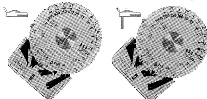
開いて測定した場合には針の示したガイドラインに青印を合わせますと同じように絞りとシャッタースピードの組合せが得られます。
