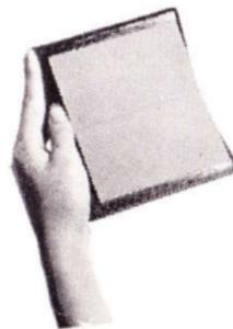
セコニック標準反射板は標準反射率18%の無彩色に塗られておるもので、どんな状態の光線でも18%より反射して来ませんから、いつでも標準の露出が得られます。カラー撮影の時や、被写体に明暗差のある物を測ったりするような時にご使用になると良い結果が得られます。
