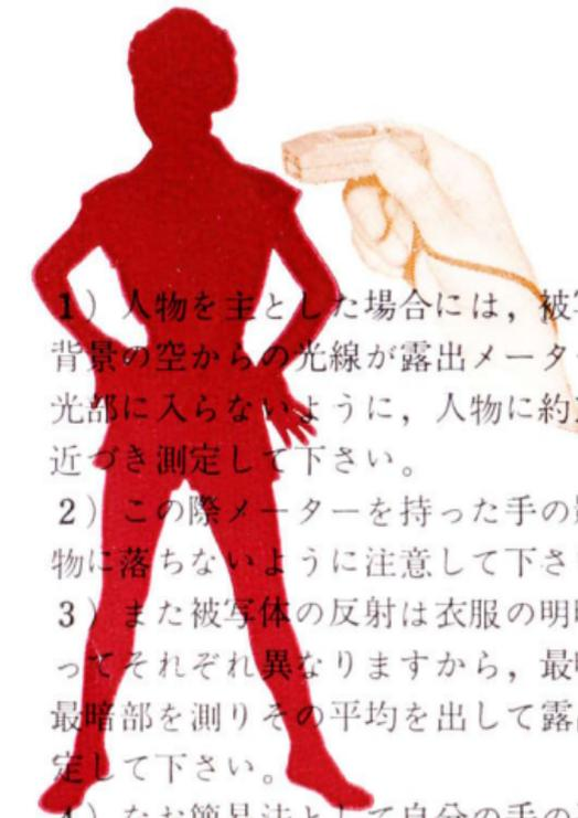
1) 人物を主とした場合には、被写体の背景の空からの光線が露出メーターの受光部に入らないように、人物に約10cm位近づき測定して下さい。
