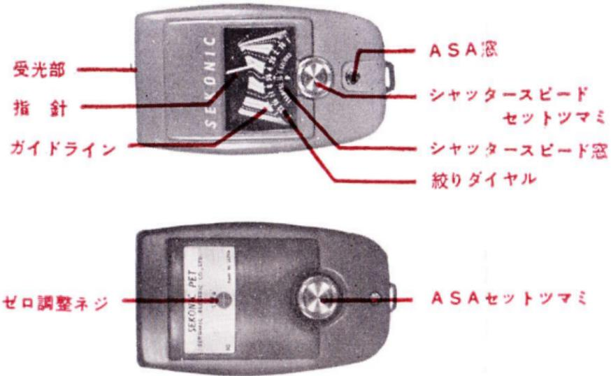
セコニック・ペットはスナップ写真に最適で反射光線式メーターです。
