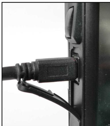
⑤露出計の電源を入れてください。正常に接続すると、液晶表示部に USBマークが表示されます。
