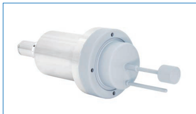
フッ素樹脂コート付きプローブ (プローブ: FVM80A-PST-T02)
